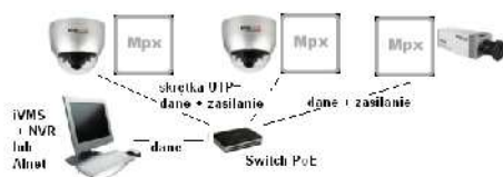
Przykład wykorzystania zasilania PoC poprzez sieć komputerową
